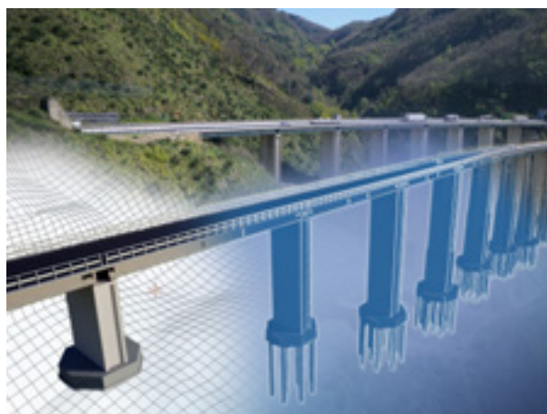
Sovrapposizione del modello BIM as-is con l'opera nell'attuale stato di fatto.
