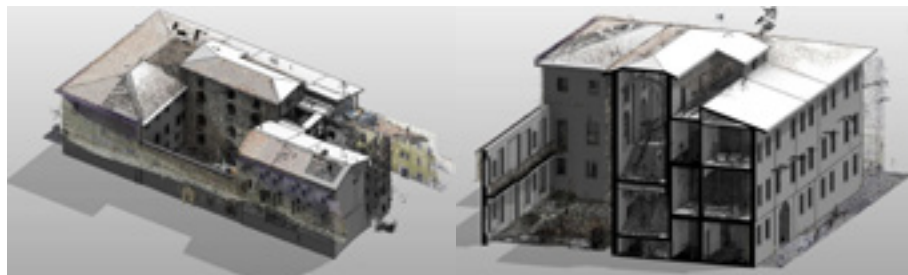
Modello BIM dello stato di progetto di palazzo Almerici sovrapposto alla nuvola di punti
