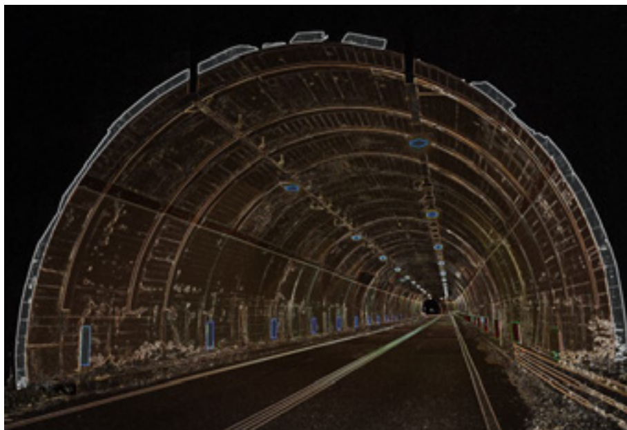
03 Modello informativo Tunnel: modello informativo per visualizzazione geometrie e acquisizione strumentale
