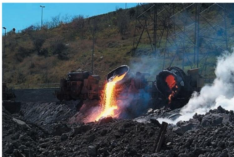
Foto 1. Lo scarico delle pariole e il raffreddamento della scoria di acciaieria.
