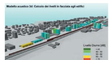
Figura 4 Vista 3d del modello di simulazione acustica.
