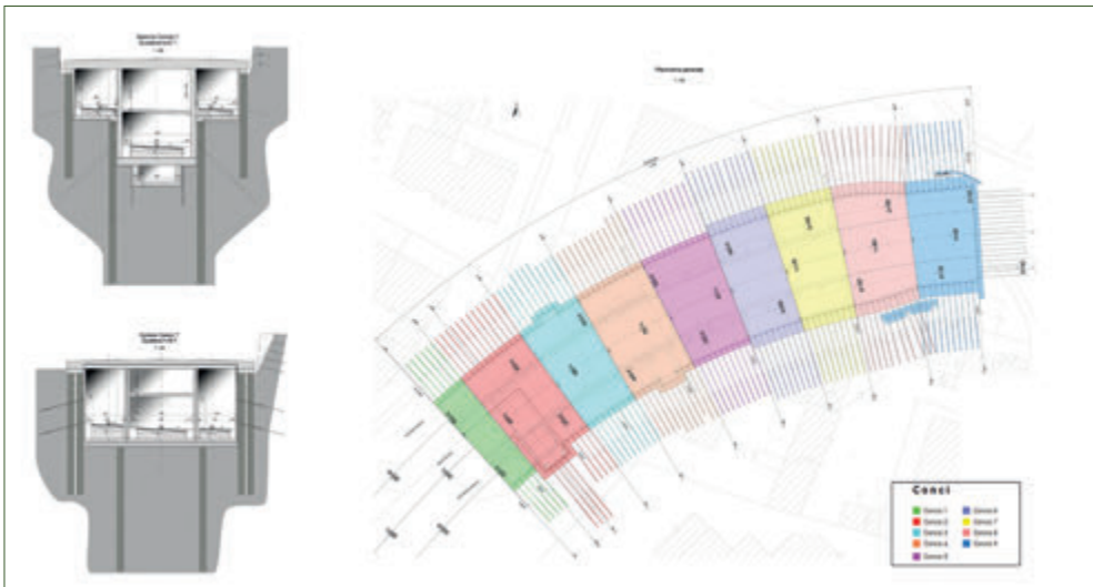
Fig 2 – Galleria Artificiale UDEC – Metodo Top Down – Schema disposizione Conci
